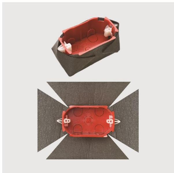
Le système se compose d'une feuille préformée de matériel intumescente à base de graphite. En case d'incendie la garniture s'étend en protégeant la boîte électrique de raccordement insérée dans le mur de compartimentage en placoplâtre.
