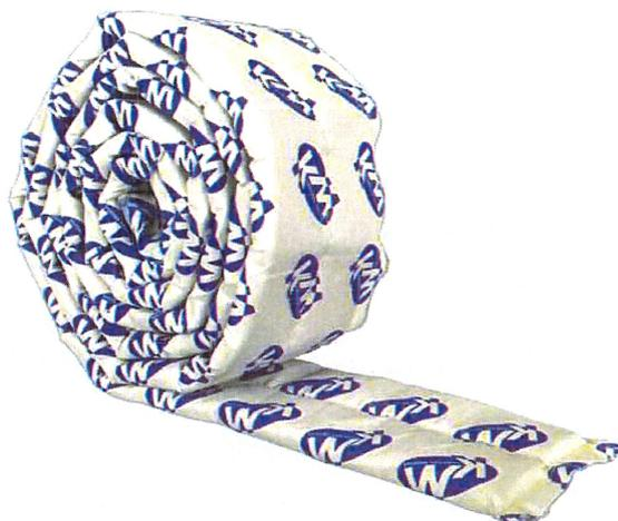
**KM-FSL** est une bande à couches multiples de tissu en fibre de verre avec du matériau thermoexpansible. Le matériau thermoexpansible s'étend avec la chaleur et scelle le passage du tuyau.
